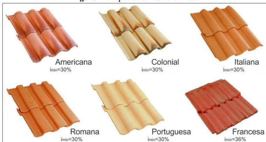
Figura 21: Tipos de telhas cerâmicas.
