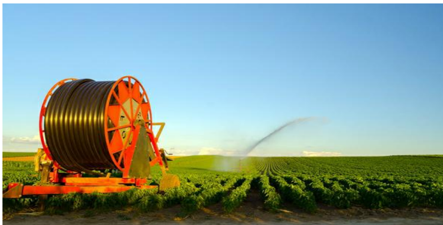
Figura 5 – Sistema de irrigação autopropelido ou carretel enrolador.
