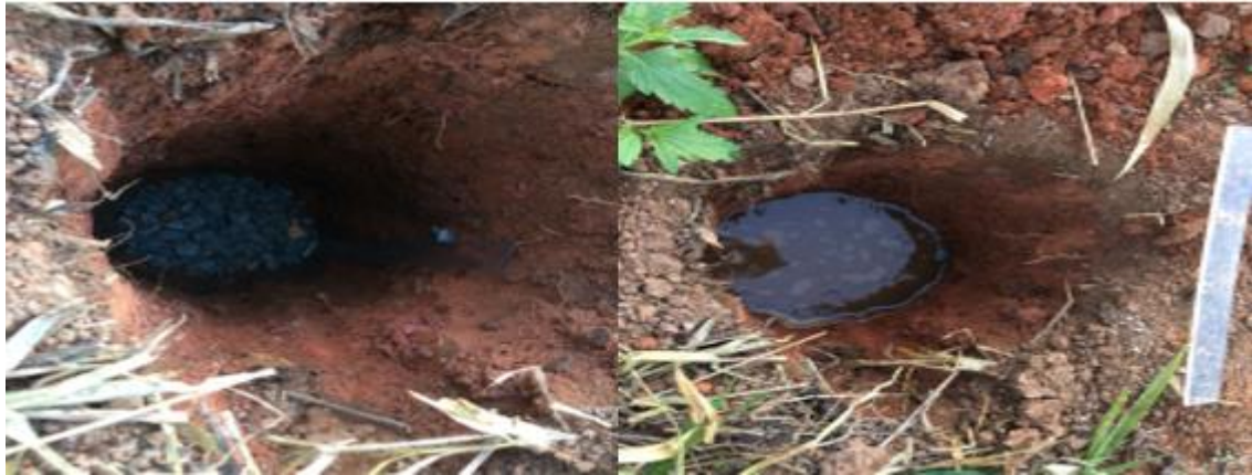
Figura 4.8. Teste para a determinação do coeficiente de infiltração do solo. Fonte: Dados de pesquisa.
