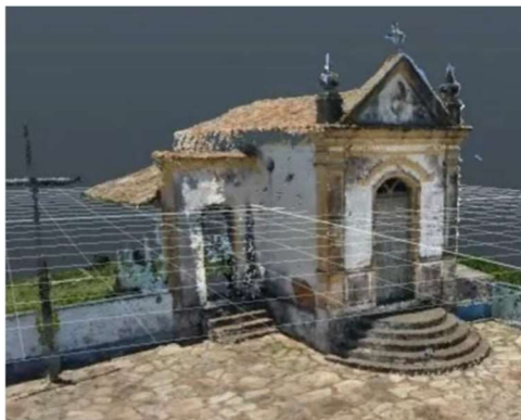
Figura 07: Nuvem de pontos e o modelo da construção ou modelo BIM gerado
