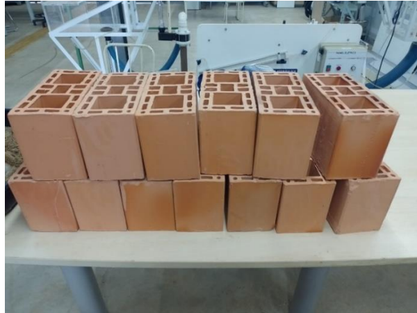
Figura 39: Sobreposição dos blocos sobre bancada plana em laboratório do IFMG Campus Avançado Piumhi.
