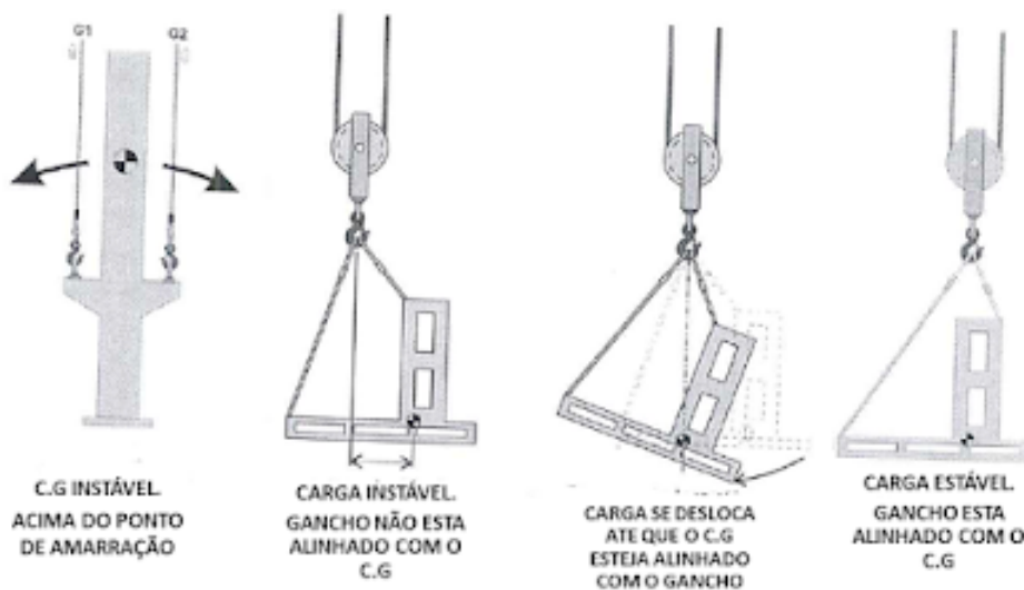
Figura 4 – Exemplo do CG em içamento de Cargas
