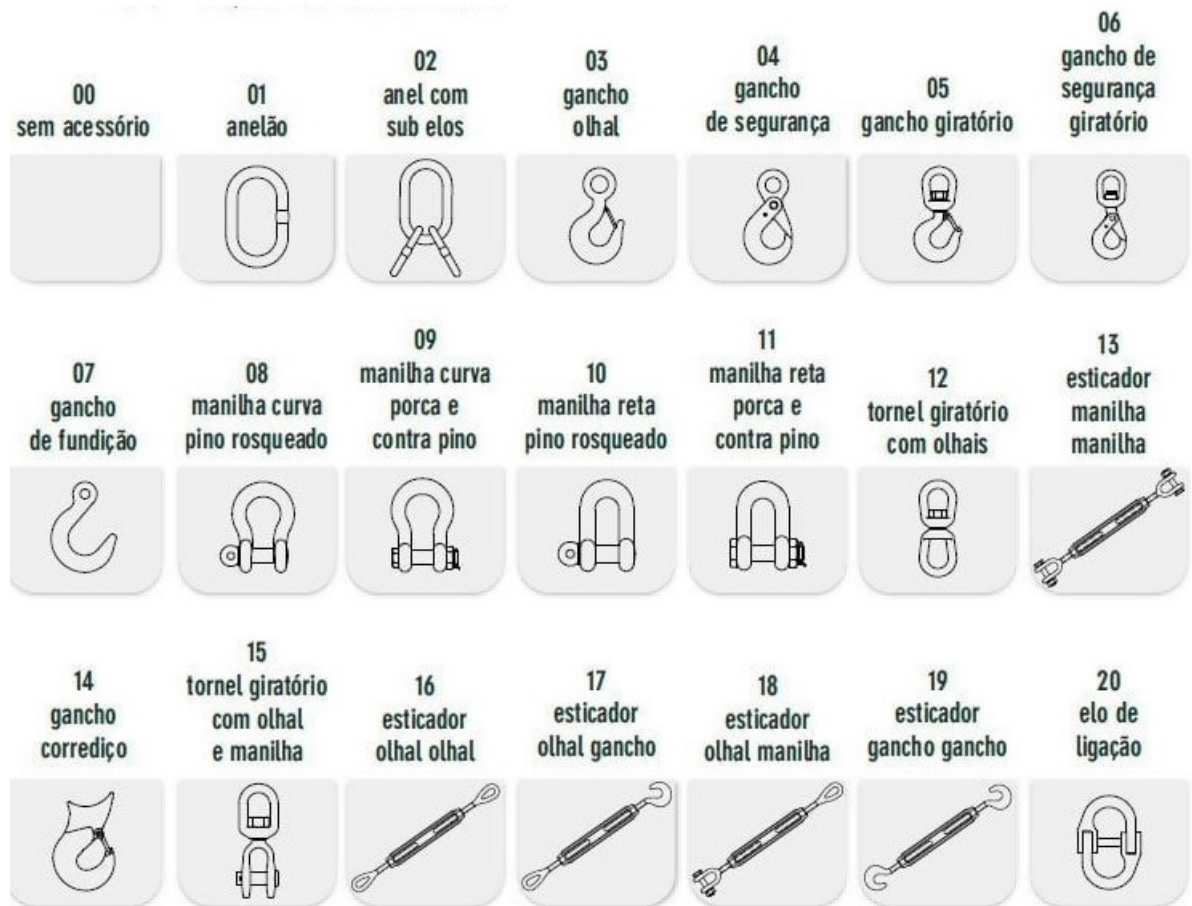
Figura 7 – Exemplo dos tipos de terminações utilizados em lingas
