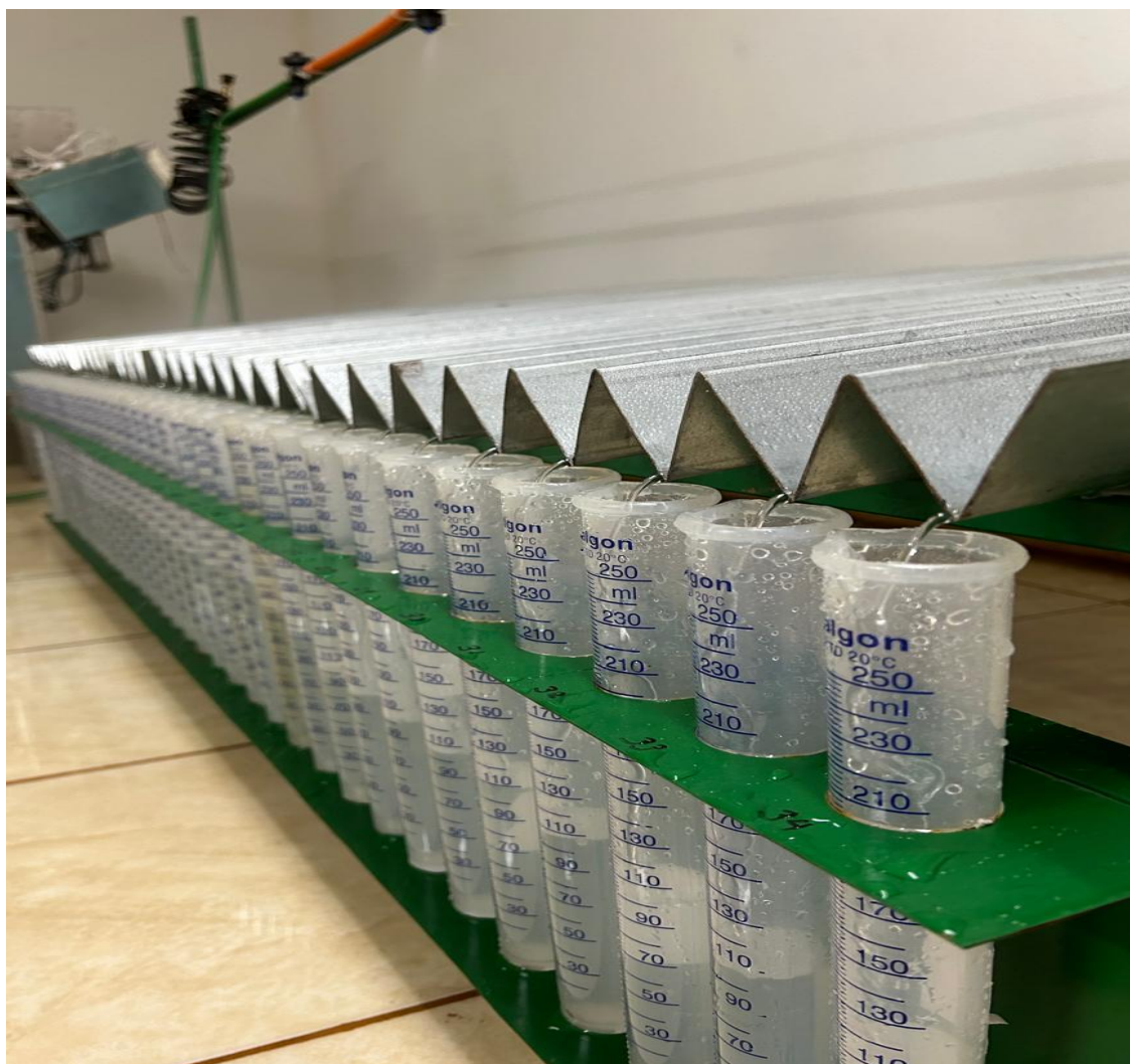
Figura 9: Coleta do volume através das provetas contidas na mesa padronizada.
