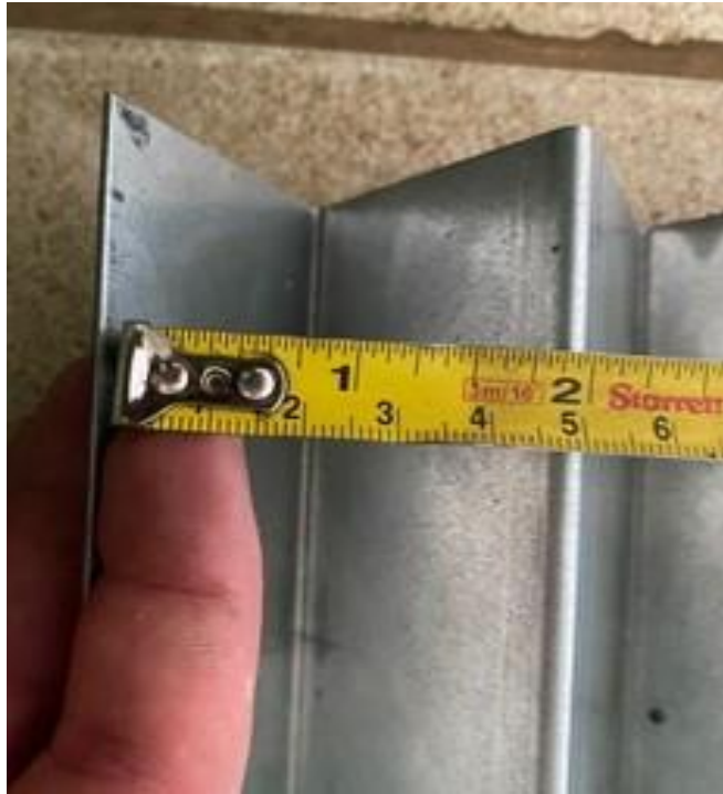
Figura 6: Conferência o espaçamento das canaletas da mesa padronizada
