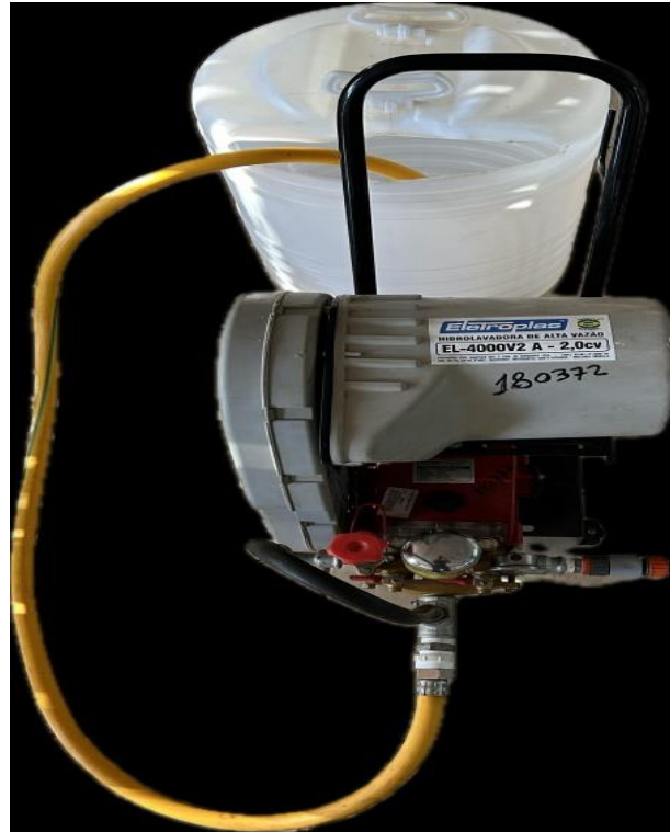
Figura 8: Bomba hidráulica 2,0 CV com regulagem de pressão.
