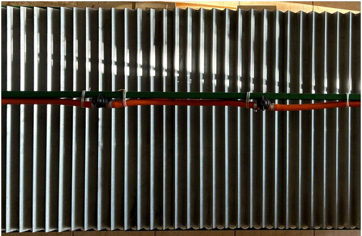
Figura 7: Posicionamento da barra de pulverização sobre a mesa padronizada
