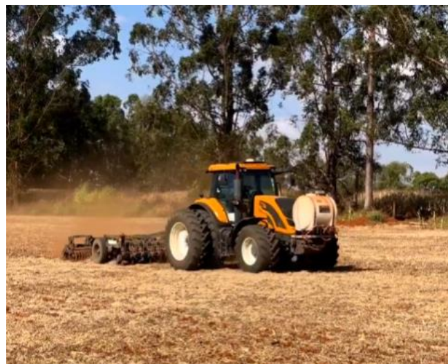
Figura 2: Conjunto utilizado no processo de escarificação.
