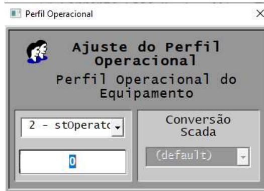
Figura 21 – Alteração do perfil operacional do disjuntor.
