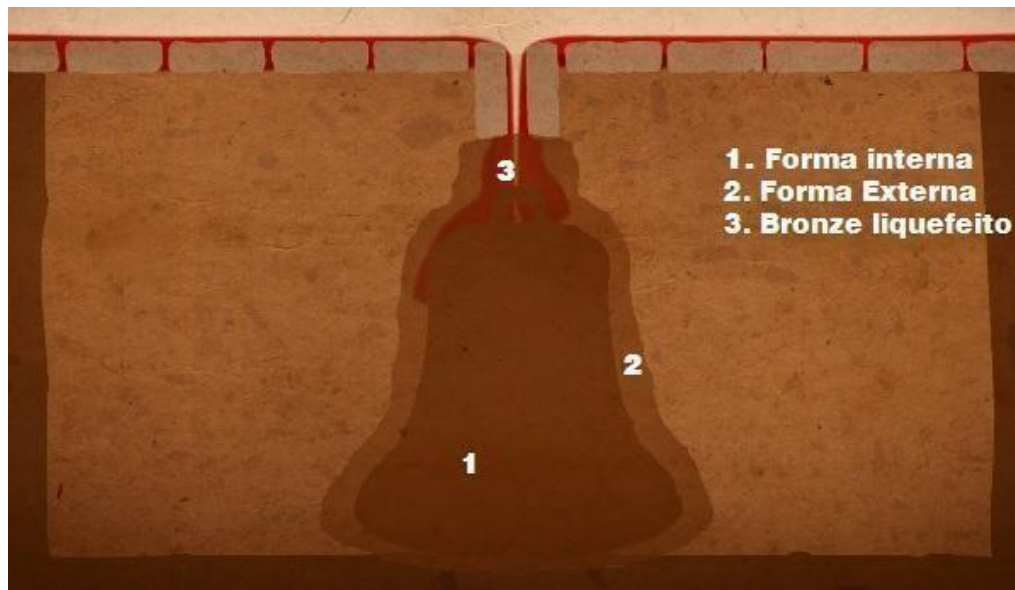
Figura 4: Fabricação do Sino - Forno. Fonte: NSC Total, 2020.
