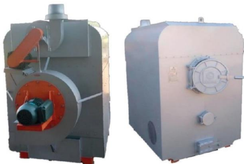
Figura 4 – Aquecedor para aviário a lenha
