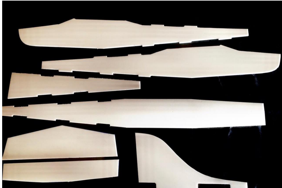
Figura 2- Cortes em poliestireno extrudado para confecção da fuselagem da RPA
