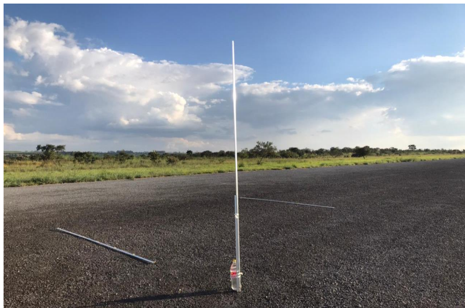
Figura 14- Baliza para referência na altura de voo da pulverização
