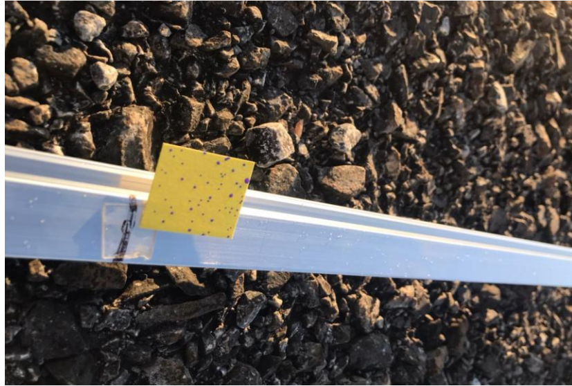
Figura 15 - Etiqueta hidrossensível após pulverização
