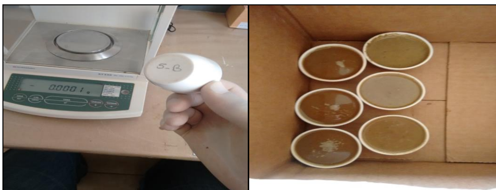
Figura 20 - Dosagem das diluições nos cadinhos Fonte: Próprio Autor, 2016
