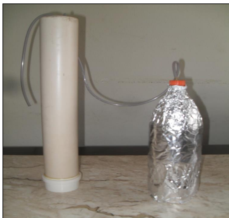
Figura 12 - Unidade de Biodigestão experimental Fonte: Próprio Autor, 2016
