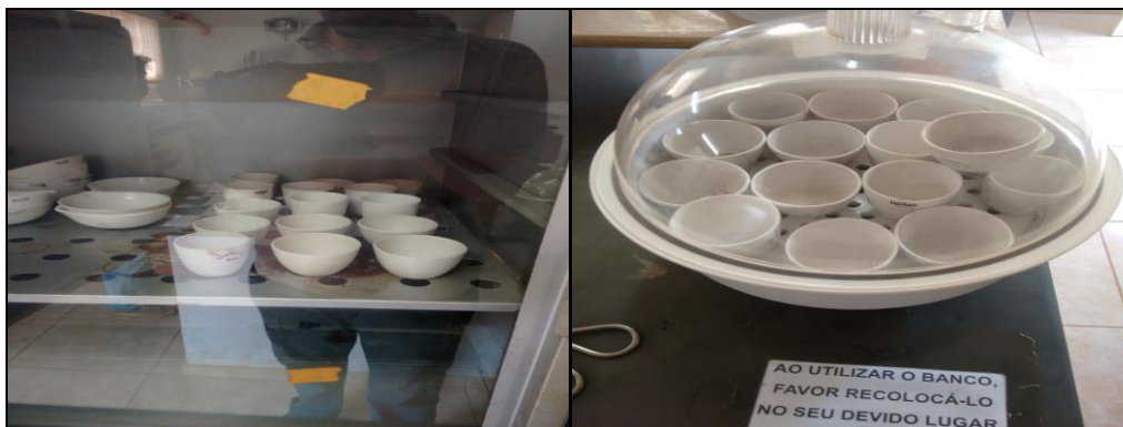
Figura 18 - Secagem dos cadinhos Fonte: Próprio Autor, 2016
