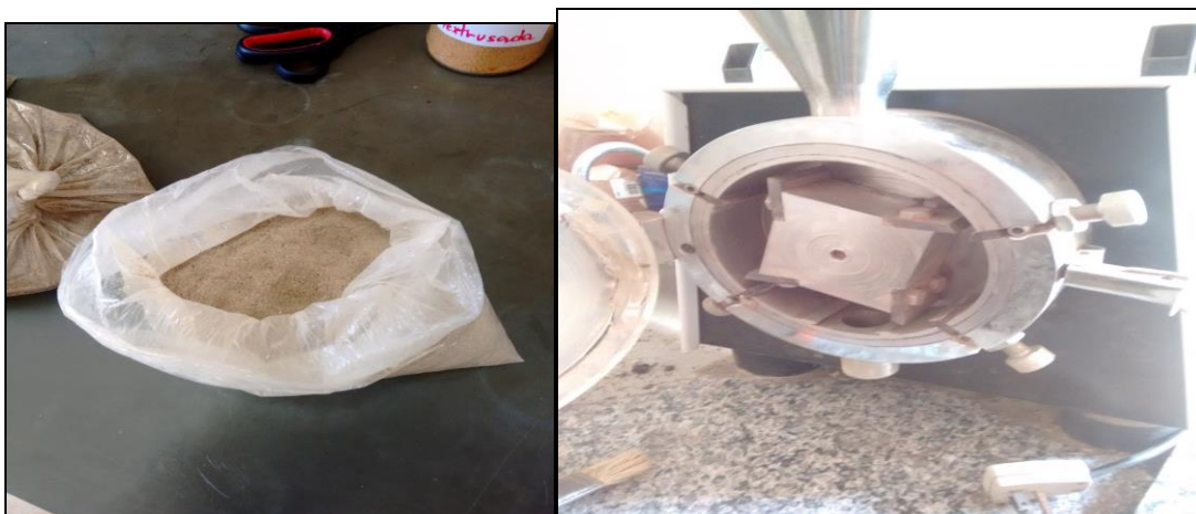
Figura 17 - Moagem: moinho e mistura final Fonte: Próprio Autor, 2016
