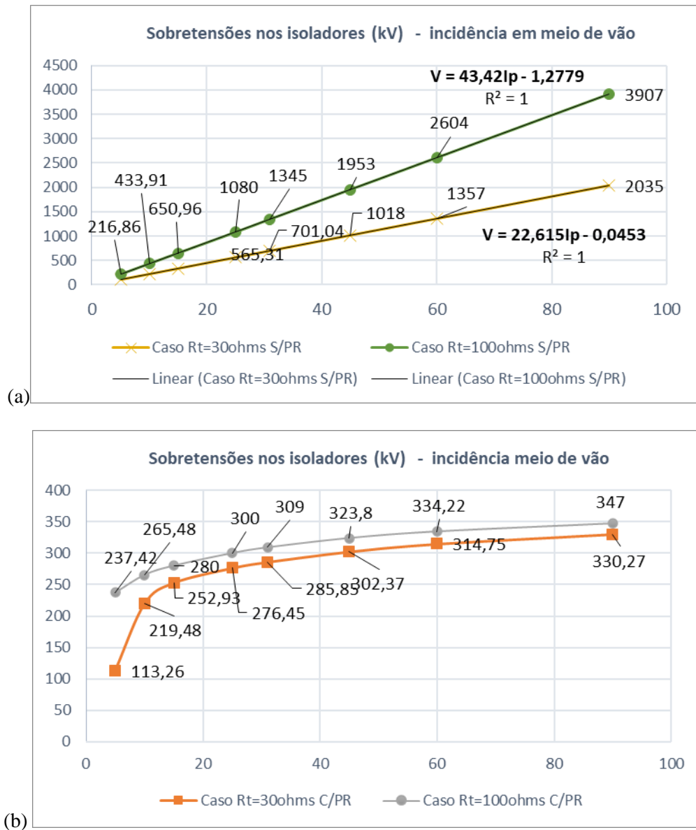
Figura 46 – Sobretensões nos terminais dos isoladores devido à incidência de descarga atmosférica em meio de vão, com resistências de aterramento de 30 \Omega e 100 \Omega . Figuras b e c correspondem ao detalhamento dos casos simulados sem e com para-raios.
