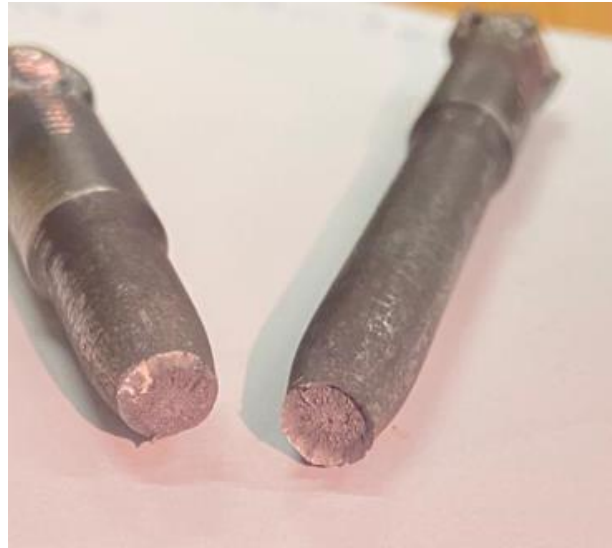
Figura 30: Corpo de prova após tração – Amostra R1.
