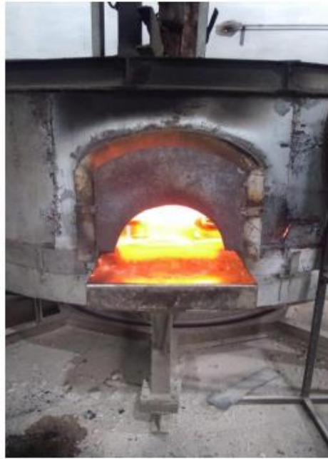
Figura 5: Têmpera de flanges, forno giratório.
