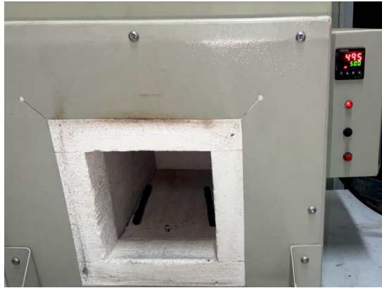
Figura 20: Corpo de prova durante aquecimento (Revenimento)
