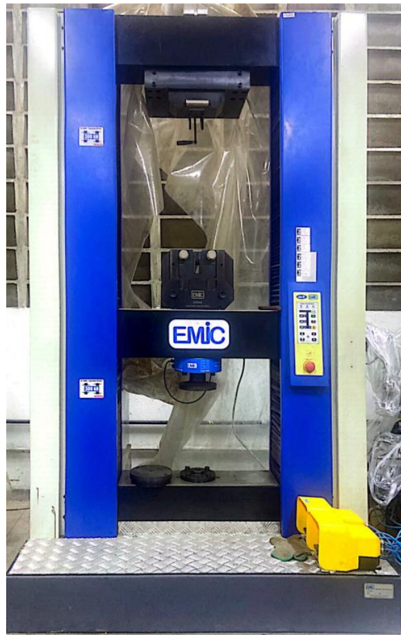
Figura 22: Máquina de tração EMIC DL-30000 (IFMG)
