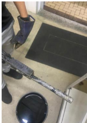
Figura 19: Corpo de prova após resfriamento (Têmpera).
