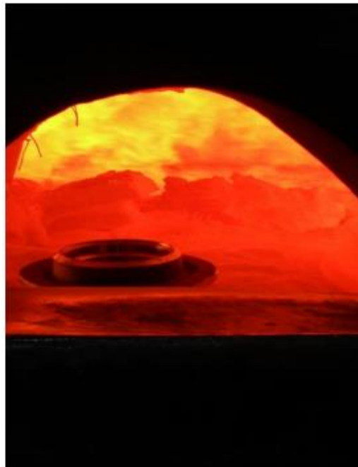
Figura 4: Têmpera de flange, aquecimento a gás.
