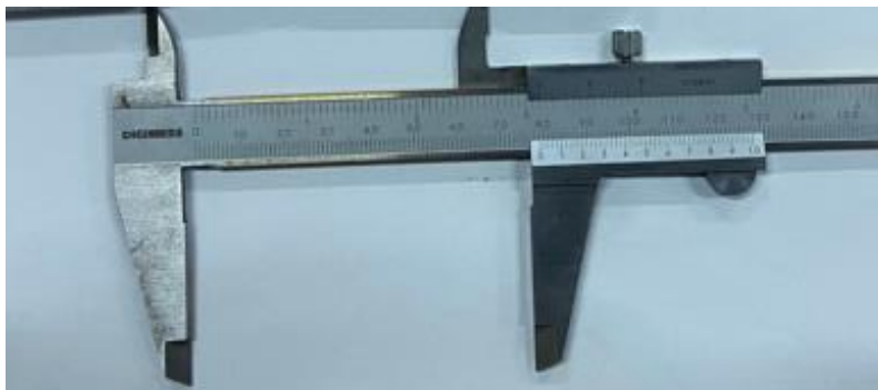
Figura 23: Paquímetro Digimes Universal 0-200mm resolução 0,02mm.
