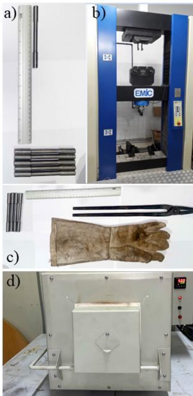
Figura 16: Materiais e equipamentos utilizados no trabalho. a) corpos de prova; b) máquina de ensaio de tração; c) alicate tenaz e luvas de proteção; d) forno mufla.
