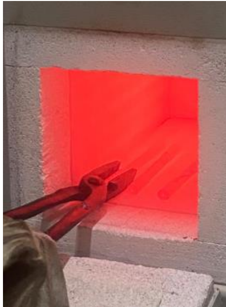
Figura 18: Peças em aquecimento (Têmpera).
