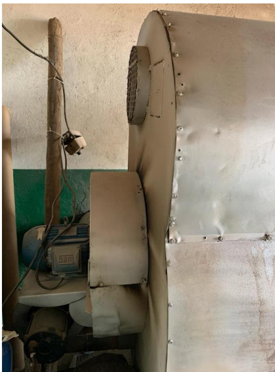
Figura 4.15 – Motor elétrico utilizado no aquecedor a lenha
