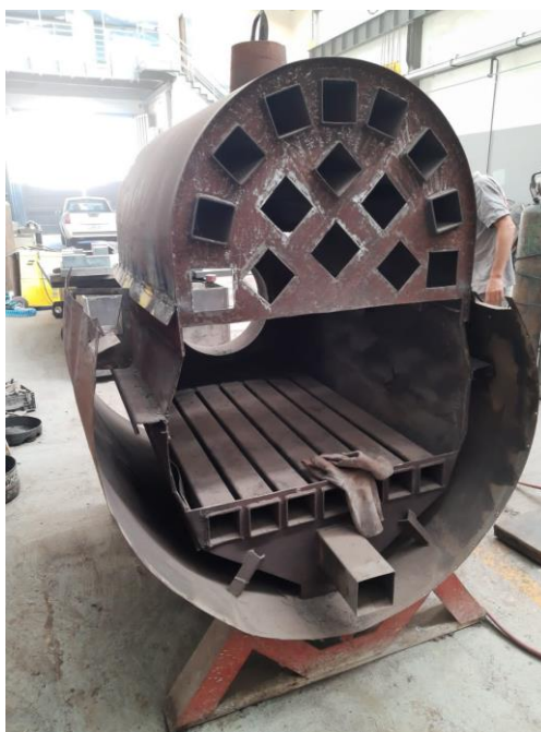
Figura 5.3 – localização dos tubos trocadores de calor
