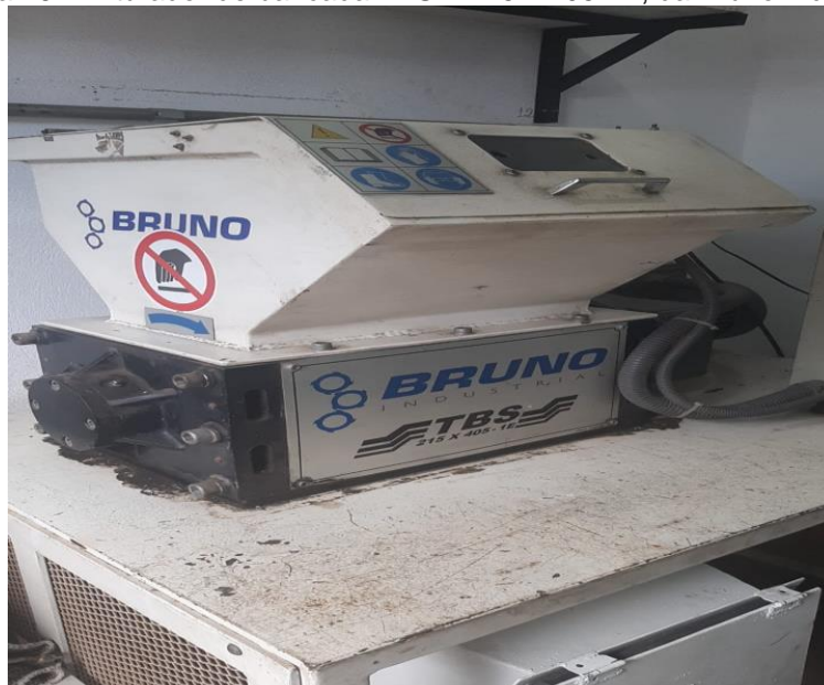
Figura 16 - Triturador de bancada TBS – 215 x 405 1E, da Bruno Industrial.
