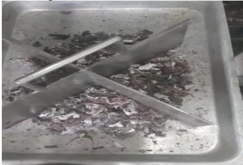
Figura 17: Quarteamento da amostra.
