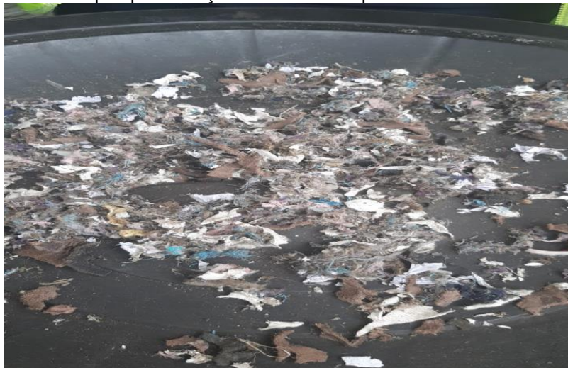
Figura 19 – Amostra após pulverização no moinho de painelas i-4227 da Contenco.
