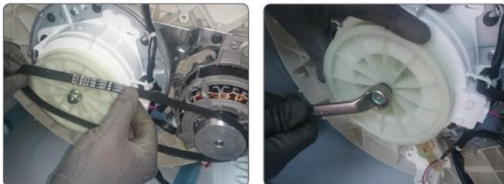
Figura 13 - Mecanismo e Motor Elétrico de Máquina de Lavar Roupas
