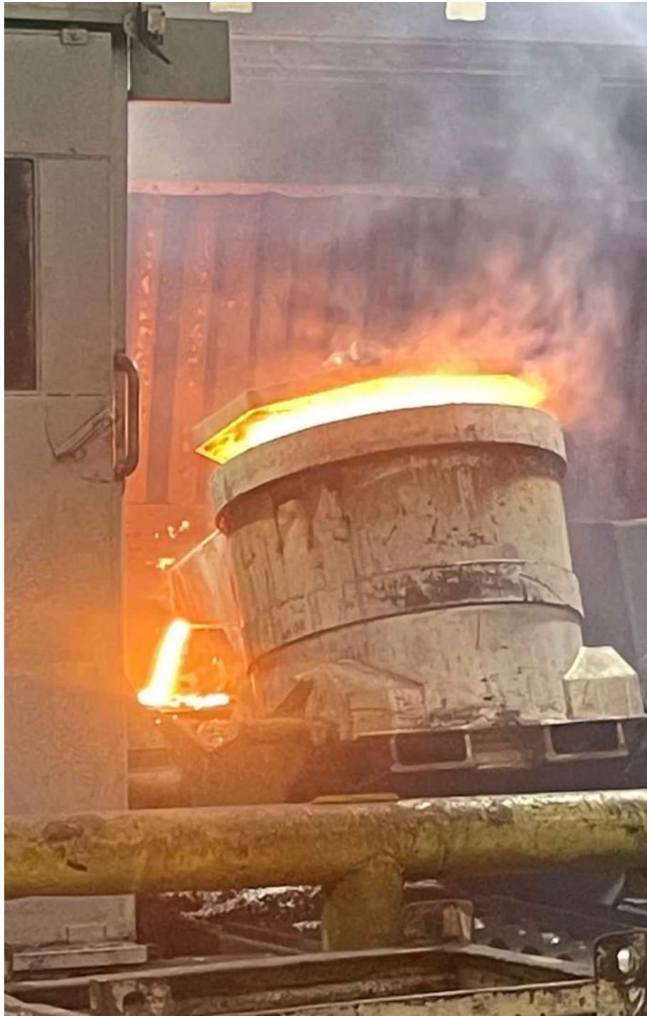
Figura 8 - Vazamento de metal líquido no molde
