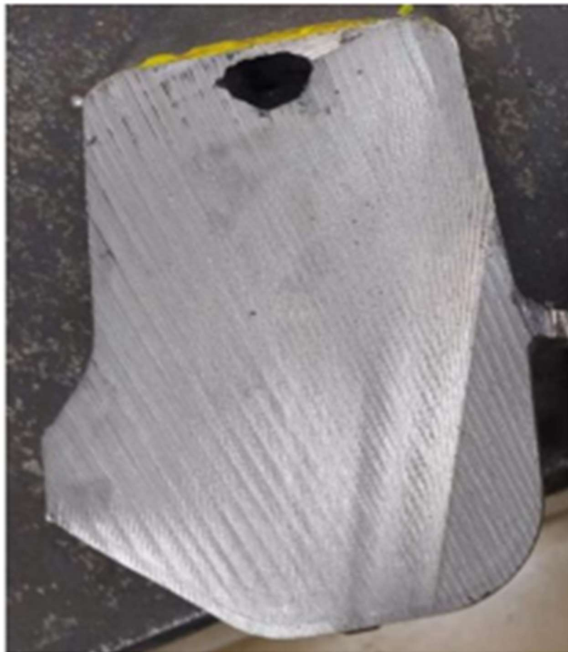
Figura 6 - Imagem de corte longitudinal de um massalote evidenciando a bolha
