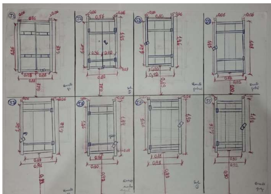
Figura 60- Croqui desenvolvido pela autora para marcação de esquadrias.
