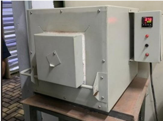
Figura 5 – Forno MUFLA utilizado para o tratamento Térmico.
