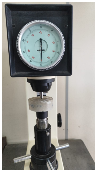
Figura 14 – Ensaio de dureza sendo realizado
