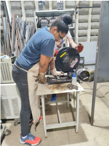
(a) Corte das amostras na serra polícorde.
