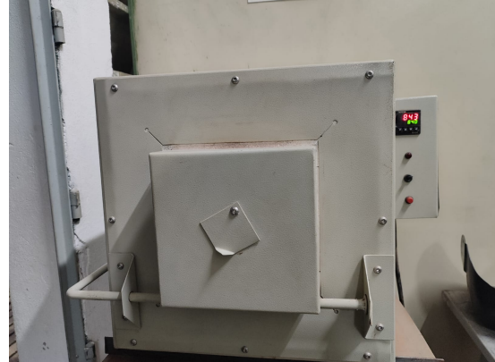
Figura 5 – Forno MUFLA utilizado para o tratamento Térmico.
