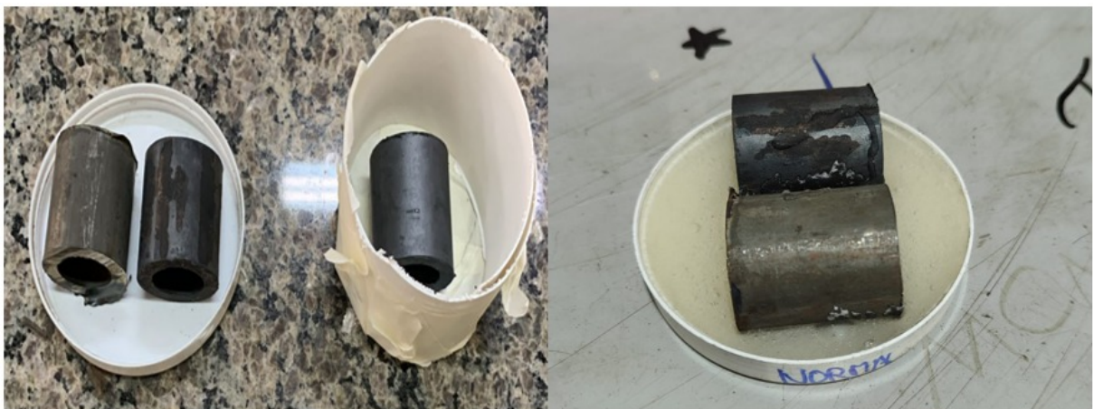
Figura 8 – Preparação para embutimento dos CP's
