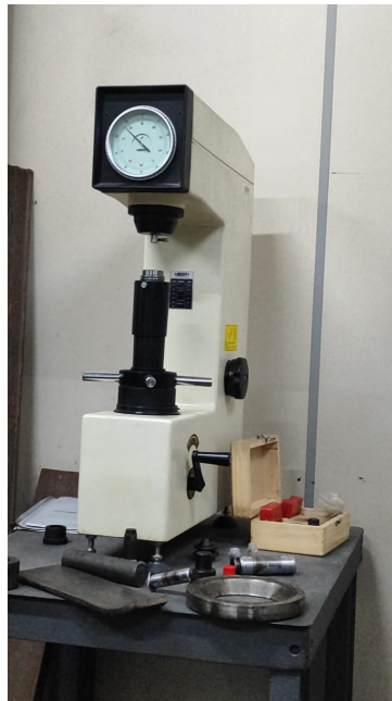
Figura 12 – Durômetro de bancada utilizado no trabalho
