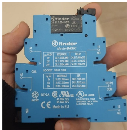
Figura 7 – Relé modular utilizado no projeto.
