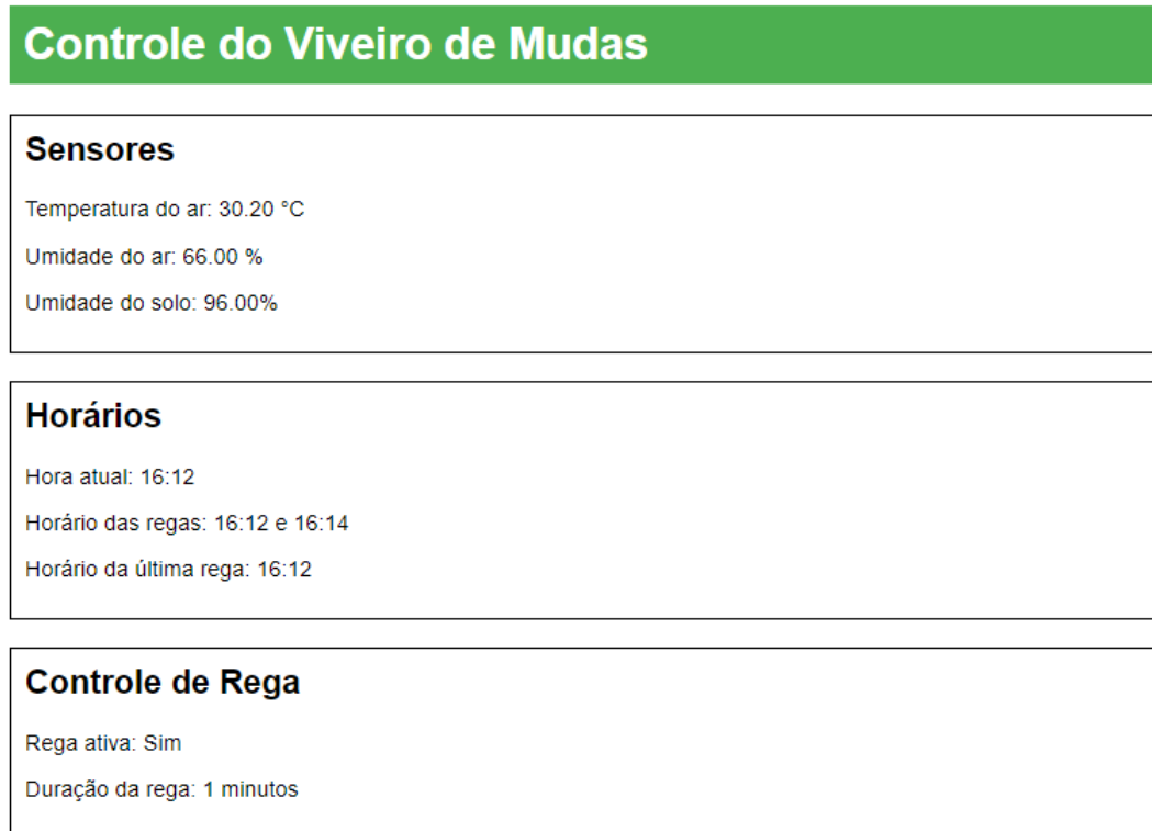
Figura 29 – Parte da página web com o monitoramento dos sensores e dos horários da rega.
