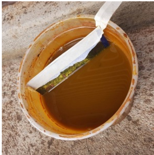
Figura 26 – Corrosão da placa no perclorato de ferro.
