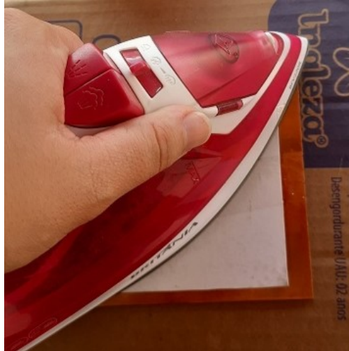
Figura 24 – Transferência do desenho no papel para a placa de circuito impresso.
