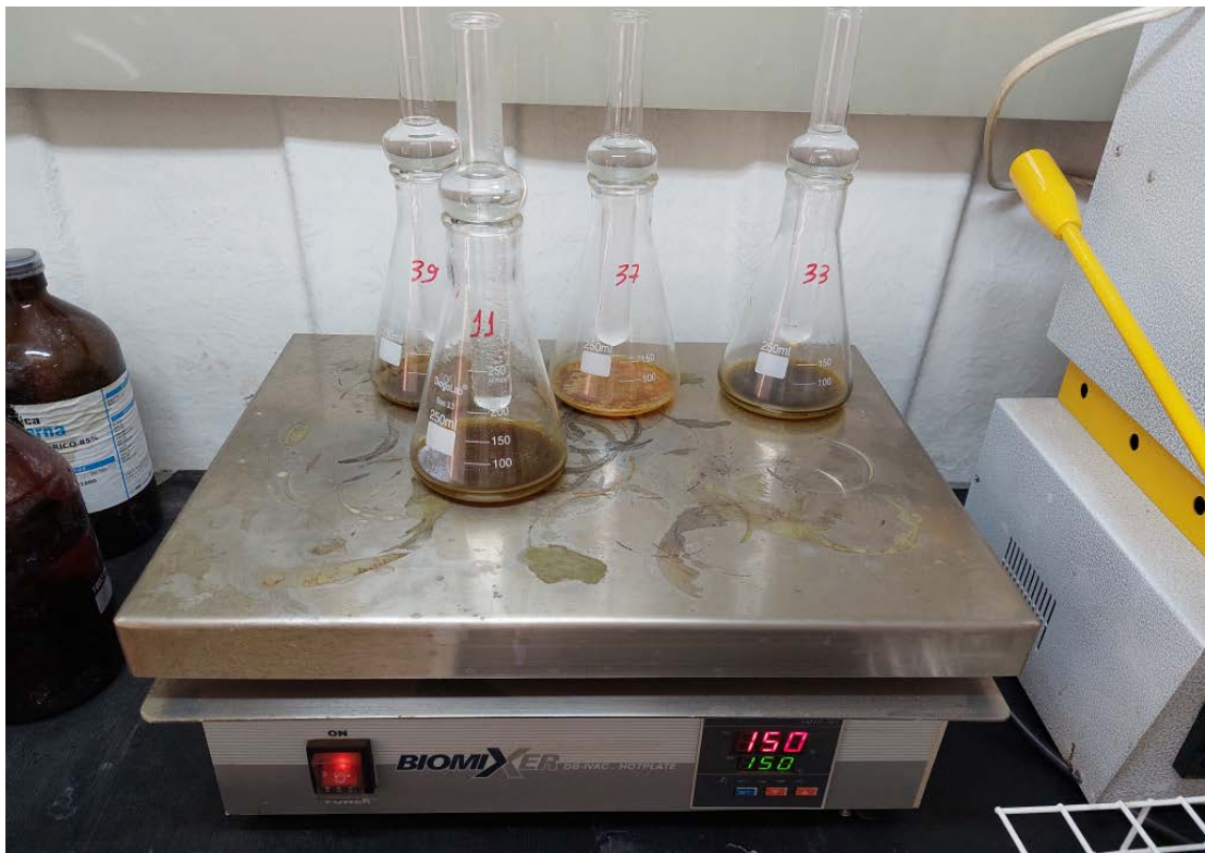
Figura 21 - Amostras com solução de dicromato sendo aquecidas na chapa.
