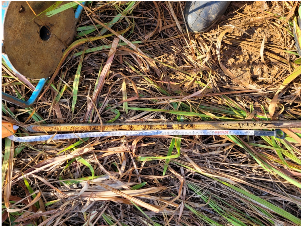
Figura 11 - Amostragem de geocoberturas das lagoas marginais feita com trado tipo sonda com alcance até um metro de profundidade.
