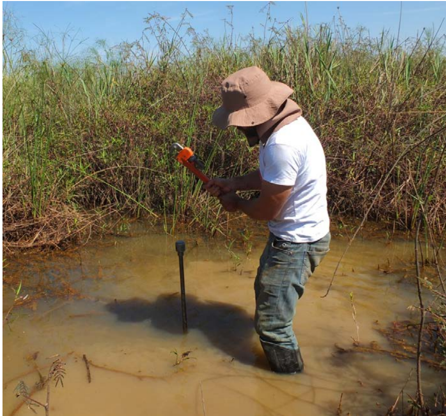
Figura 9 - Coleta das amostras feitas com o auxílio de trado tipo sonda.
