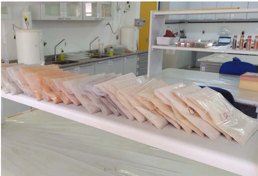
Figura 18 - Amostras secadas, peneiradas, preparadas e identificadas para análises químicas.
