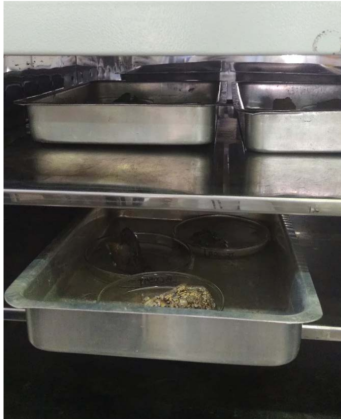
Figura 17 - Amostras com excesso de umidade sendo secadas em estufa à 40° C.
