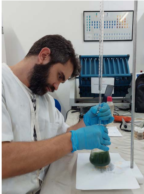
Figura 24 - Titulação das amostras com a solução de sulfato ferroso amoniacal.
