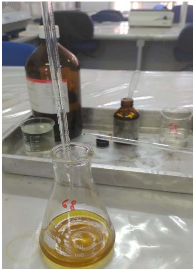
Figura 23 - Adição de ácido ortofosfórico e indicador difenilamina na solução com amostra.
