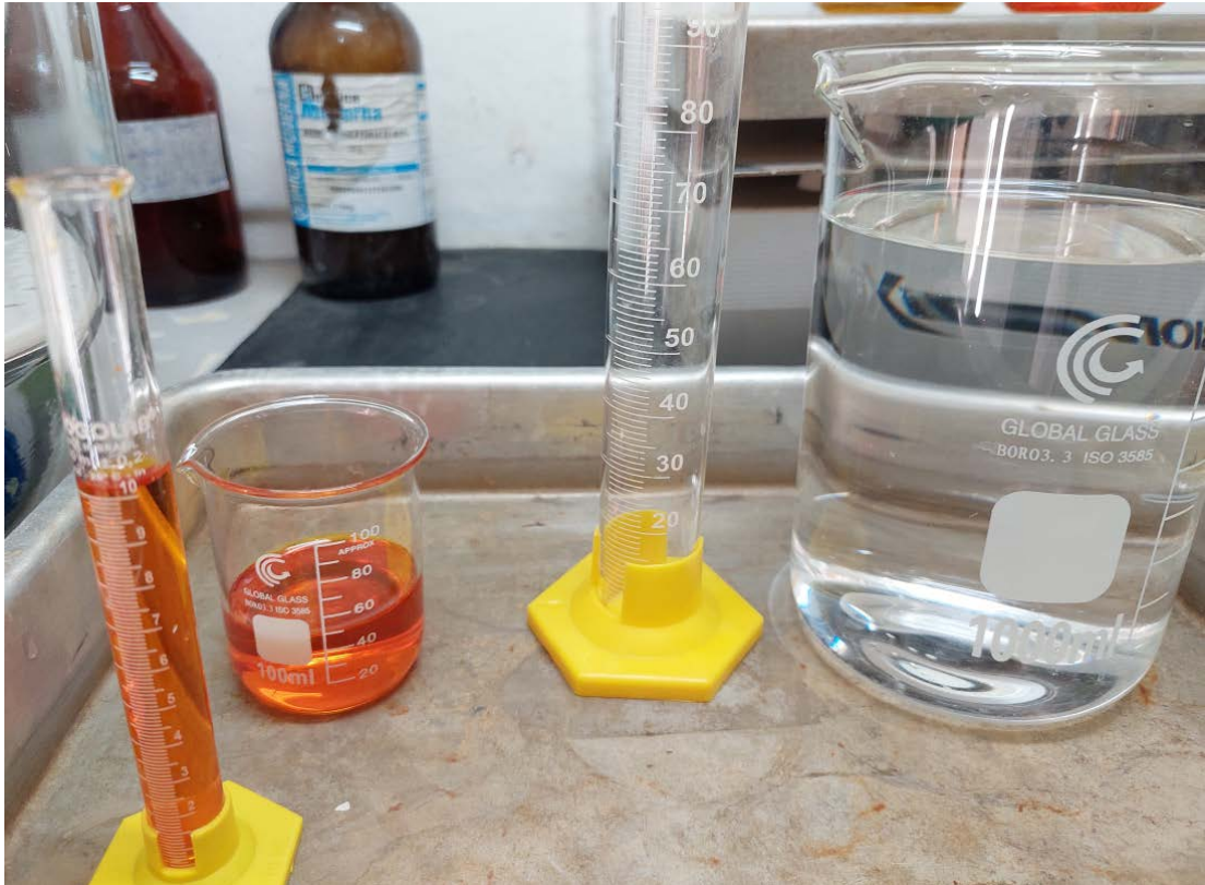
Figura 20 - Solução de dicromato de potássio utilizada para oxidar a matéria orgânica das amostras.
