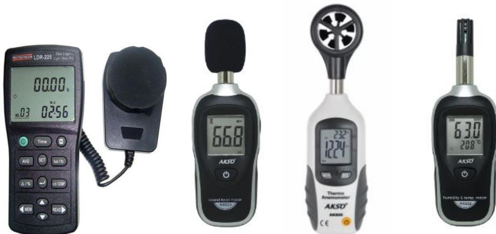
Figura 2 - Luxímetro Digital LDR 225; Decibelímetro Digital K824; Termo anemômetro Digital AK800; Termo Higrômetro Portátil AK632
