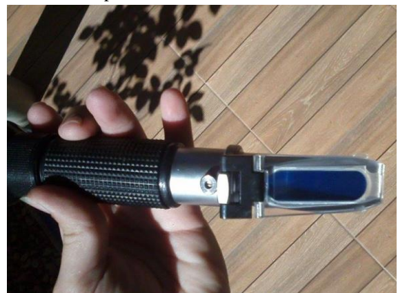
Figura 7 - Aferição do teor de sólidos solúveis totais (SST) da polpa homogeneizada dos frutos em refratômetro portátil.
