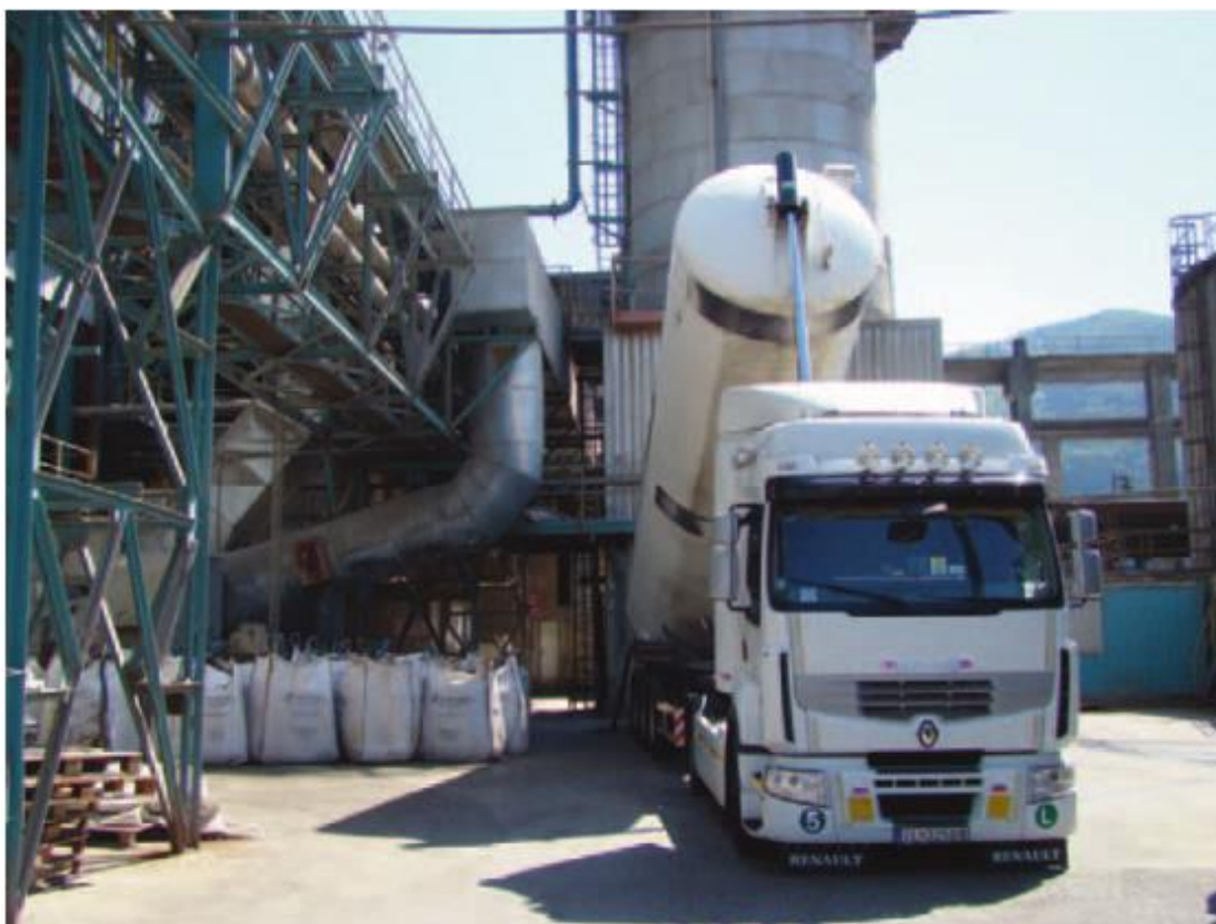
Figura 11 - Caminhão Silo descarregando FCO na fábrica de cimento.
