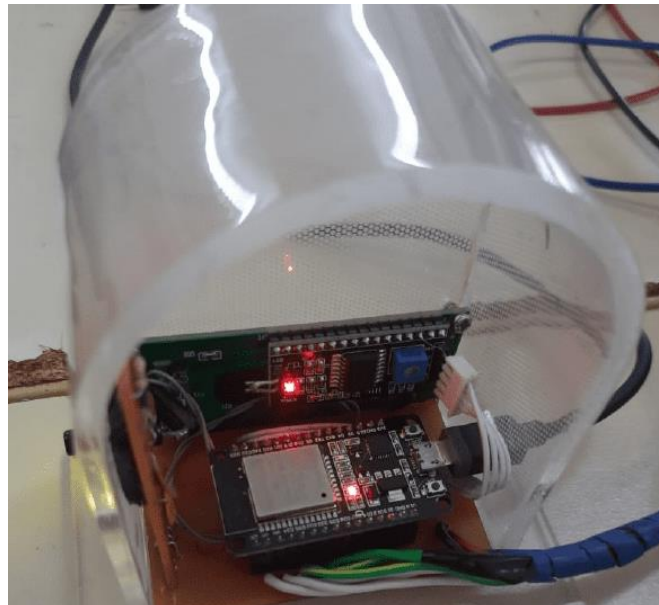
Figura 43: Implantação do circuito na caixa de proteção do rotor
