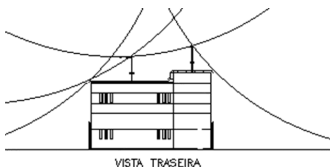
Figura 24 – Verificação de proximidade entre o método Esfera Rolante
