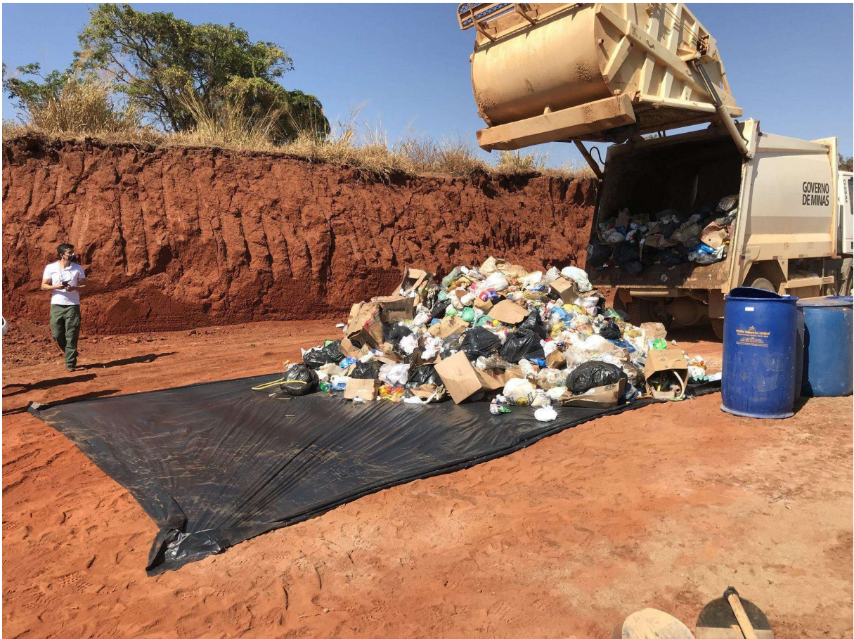
Figura 8 – Despejo dos resíduos sólidos urbanos de Doresópolis sobre lona plástica
