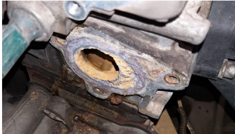
Figura 3 – Corrosão na lateral do cabeçote utilizando água pura como fluido de arrefecimento.
