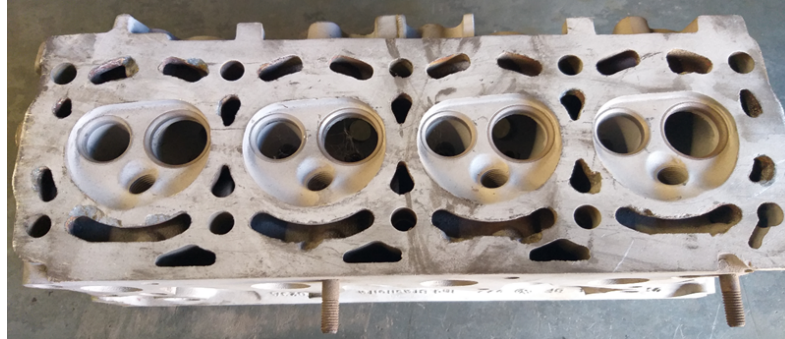
Figura 14 – Cabeçote de motor VW EA111 1.0 litro com pontos de corrosão.
