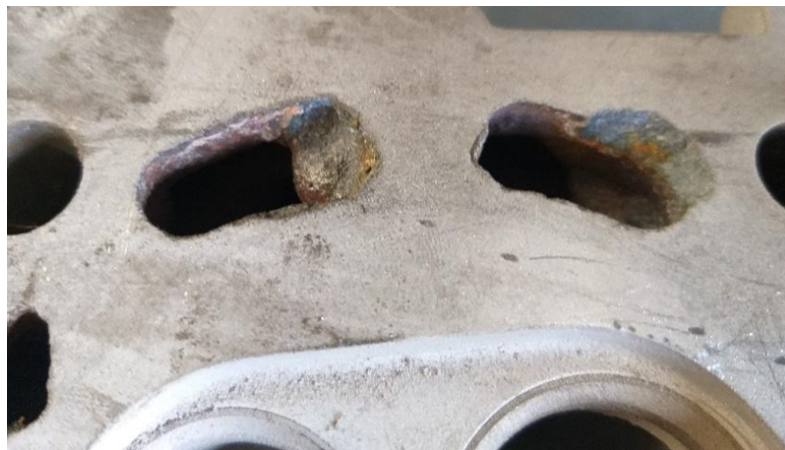
Figura 4 – Corrosão em cabeçote que utilizava líquido de arrefecimento suspeito.
