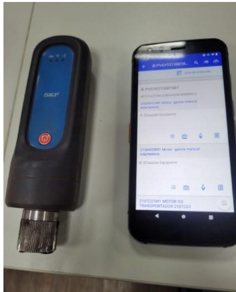
Figura 35 – Instrumento SKF para coleta de vibração.
