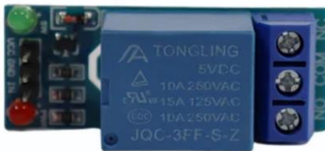
Foto 3 – Módulo Relé 5 VDC
