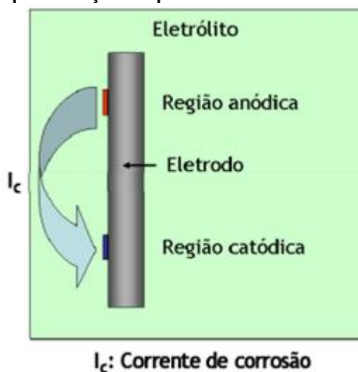
Figura 6 – Representação do processo de corrosão eletroquímica
