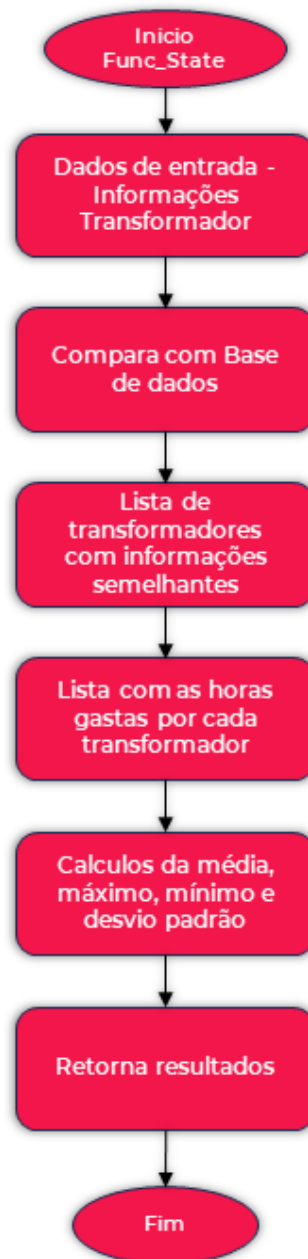
Figura 16 – Fluxograma Função "Func_State".
