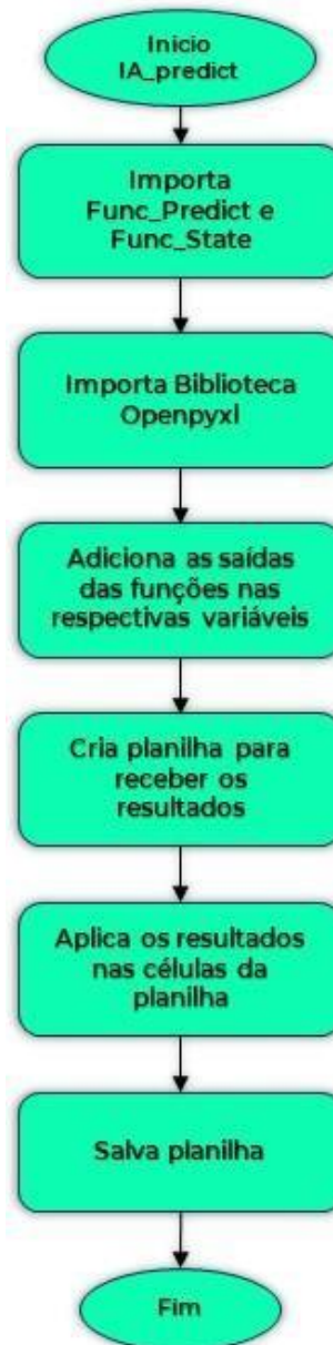
Figura 17 – Fluxograma Função "IA_Predict".
