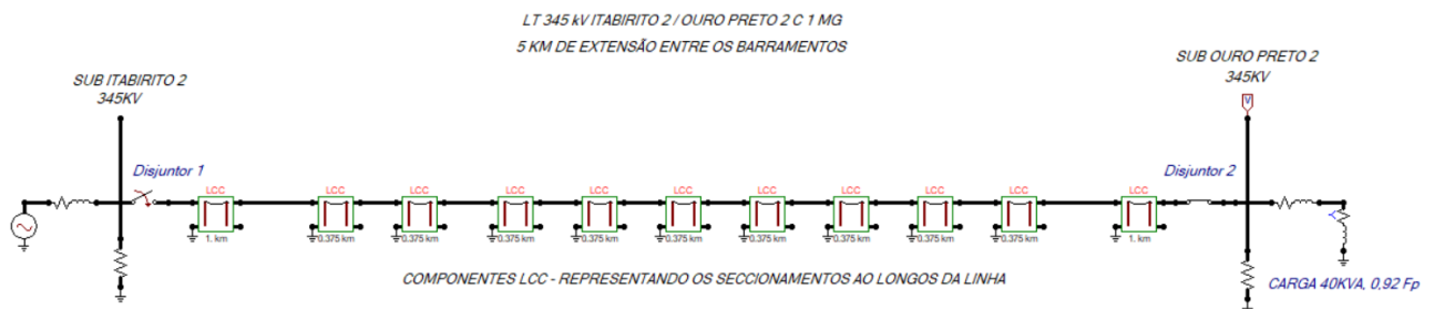
Figura 19 - Linha de transmissão projetada
