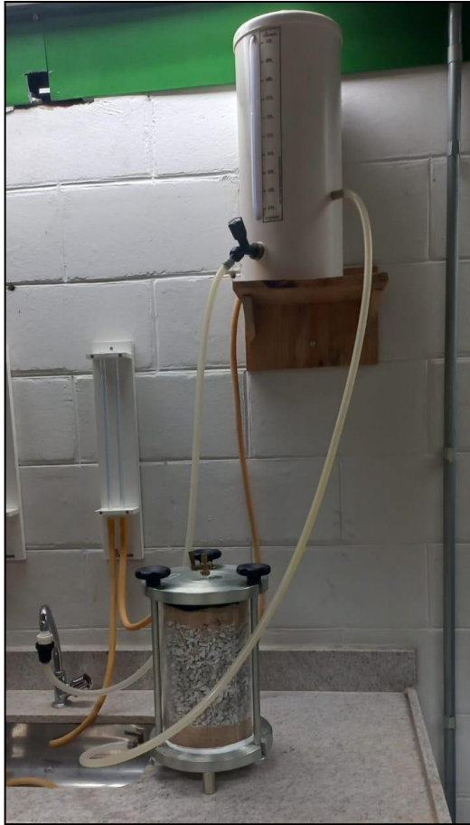
Cap III Figura 6 – Ensaio de permeabilidade
