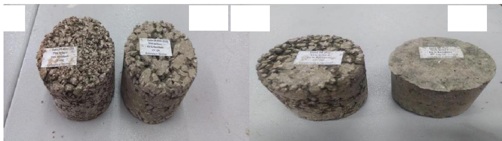
FIGURA 1 – Imagem de um exemplar de cada conjunto de amostra, sendo: (a) Amostra 1; (b) Amostra 2; (c) Amostra 3; (d) Amostra 4.
