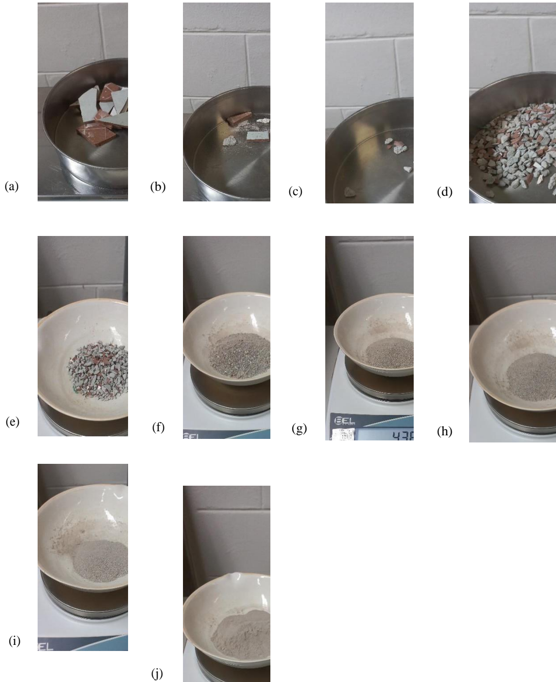
Cap III Figura 9 - Resíduo de cerâmica retido nas peneiras: 37,5 mm (A); 19,0 mm (B); 9,5 mm (C); 4,75 mm (D); 2,36 mm (E) 1,18 mm (F); 0,6 mm (G); 0,30 mm (H); 0,15 mm (I); 0,15 mm > (J).
