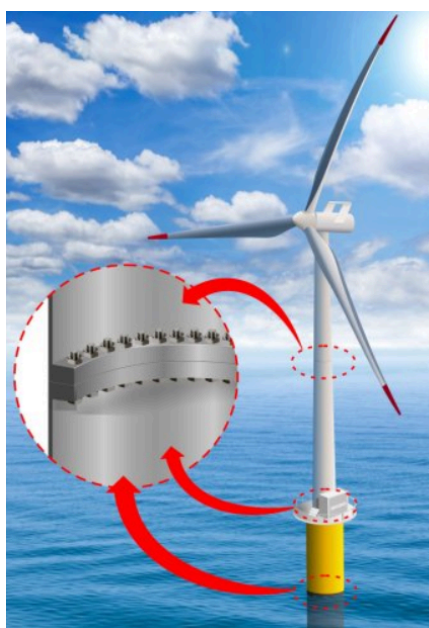
Figura 18 – Ligação Flanges Soldadas em Aerogeradores
