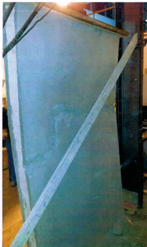
Figura 5 - Visualização do local da ruptura - Vista por trás da peça.
