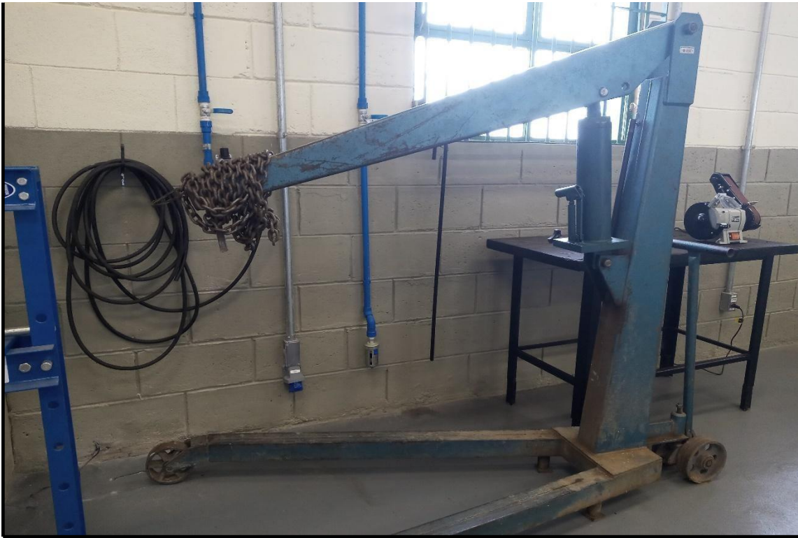
Figura 41 - Guincho Hidráulico (item em uso)
