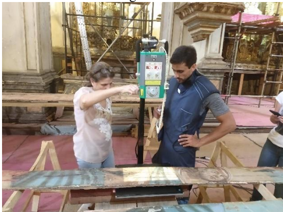
Figura 45 - Investigação de policromias subjacentes por metodologia de Raio-X.
