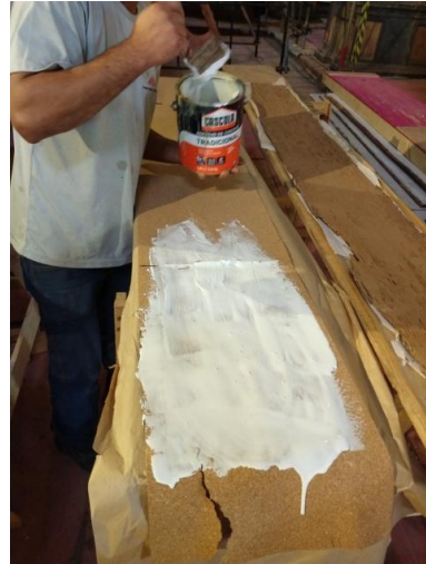
Figura 36 - Aplicação de adesivo sintético sobre folha de cortiça.
