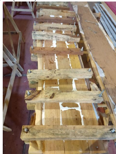
Figura 38 - Ajustes e prensa dos objetos até o tempo de secagem (7 dias).
